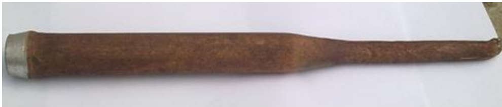
Рис. 2. Заготовка длиной 300 мм после сварки взрывом
