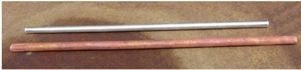
а) б) Рис. 3. Удлиненные заготовки под сварку взрывом (а), засыпка ВВ в составной контейнер (б)
