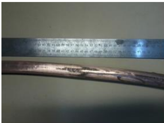
Рис. 4. Длинномерная коаксиальная заготовка после сварки взрывом: а) общий вид, снизу - без вакуума, сверху - с вакуумом, направление детонации слева направо; б) пузырь на поверхности; в) разрыв лакирующего слоя, снизу - без вакуума, сверху - с вакуумом
