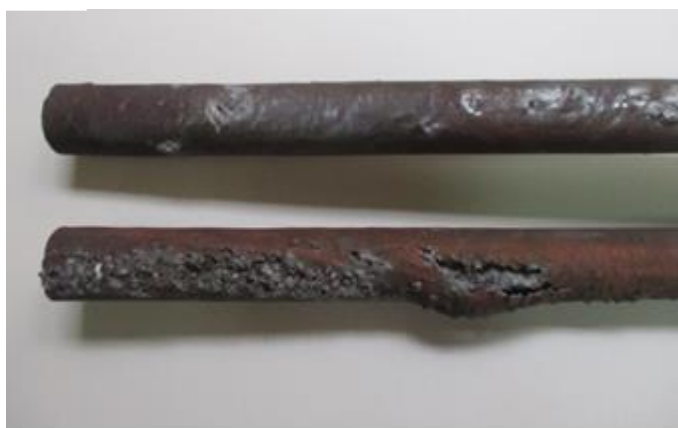
Рис. 4. Длинномерная коаксиальная заготовка после сварки взрывом: а) общий вид, снизу - без вакуума, сверху - с вакуумом, направление детонации слева направо; б) пузырь на поверхности; в) разрыв лакирующего слоя, снизу - без вакуума, сверху - с вакуумом
